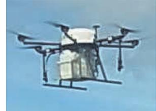
写真 薬剤散布に使用するドローン
