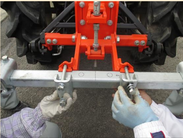
③穴なし 50 角フレームを取り付ける
