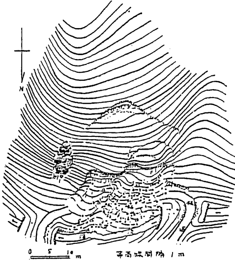
(21) 山脚末端基部の林道切取によつて生じた崩壊，上部に著しい亀裂を生じている。(1b) (結晶片岩)
