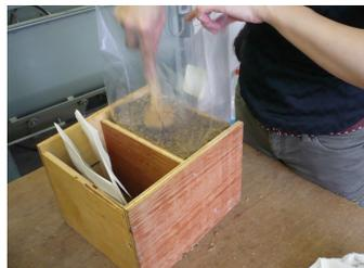
型枠を作成し隙間なく整形
