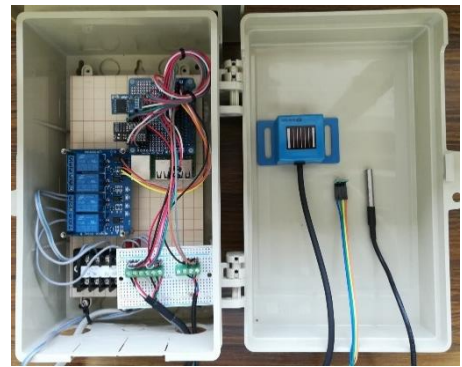
図3 センサ類を実装した日没後加温制御装置
