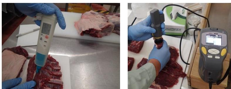
図1 pH（左図）と肉色（L\*, a\*, b\*）（右図）の機器測定の様子
