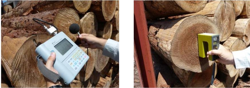
図1 打撃音（左）と心材含水率（右）の測定
