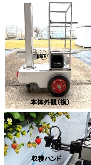
図2 イチゴ収穫ロボット 注) 「ロボつみVer.3」(株)アイナックシステム社製
