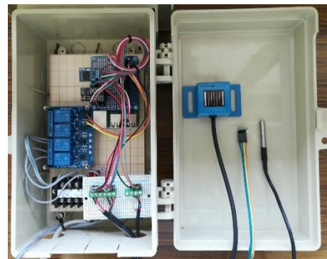
図3 センサ類を実装した日没後加温制御装置（平成30年）
