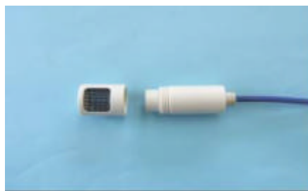
図 1-b センサーの培養土充填部位
