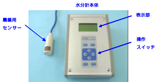
図 1-a 熱流束式センサー部と制御装置
