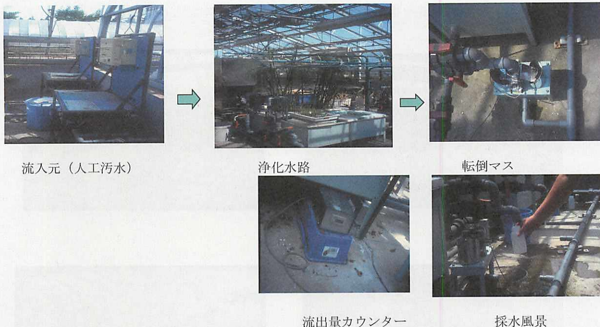
第4-4図 バイオジオフィルター浄化試験における水の流れ。
