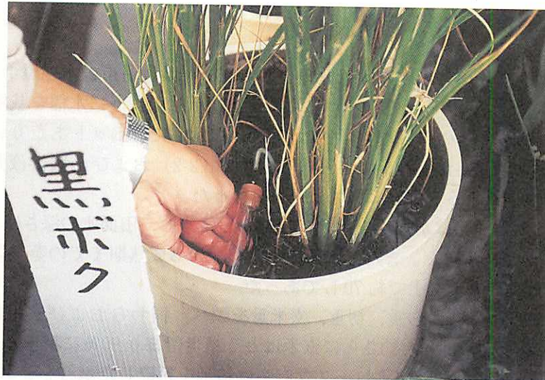
図 3.2-2 ポーラスカップと真空採血管による土壌溶液の採取
