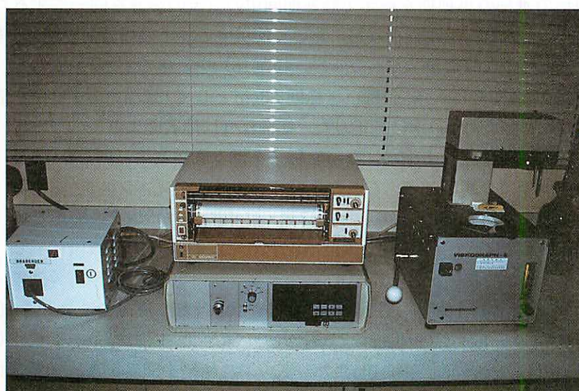
第3－2図 ブラベンダー社製のビスコグラフE型 アミログラム特性の最高粘度とブレイクダウンを計測する機械。
