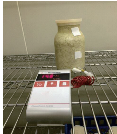
第 1 図 ガス分析計 Check Point を用いた培養期間中の培地内 CO 2 濃度と O 2 濃度の測定
